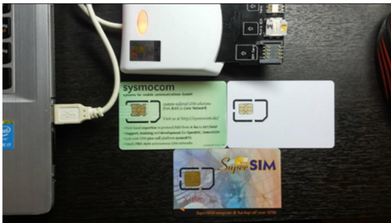
Para realizar la programación de las SuperSIM, es necesario usar un software y un hardware que sea compatible con la norma ISO-7816-4 (ISO/IEC, 2013), quien rige la construcción de las tarjetas inteligentes "Smart Card", entre ellas incluidas las tarjetas SIM, para esto se
