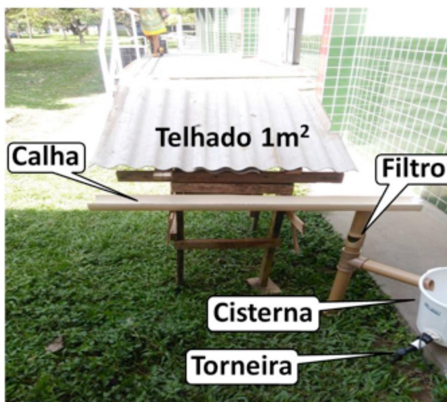
**Figura 1:** Protótipo para captação de águas pluviais
